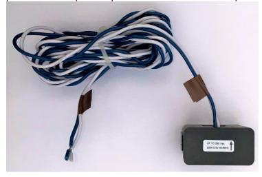
Avant d'installer les TC, identifiez chacun d'eux à l'aide d'un ruban isolant de couleur différente, un morceau près du TC et une autre près de l'extrémité du câble - même si le parcours du câble est court. Cela permettra d'identifier facilement la bonne phase lors de l'arrivée à l'Envoy et d'éviter les erreurs.
